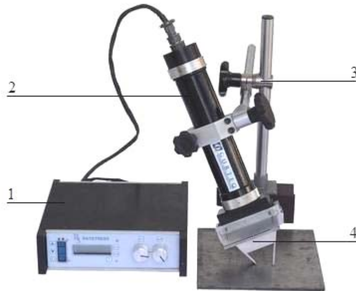
Fig. 3: Equipamento portátil de raios-X para medição de tensões mecânicas
